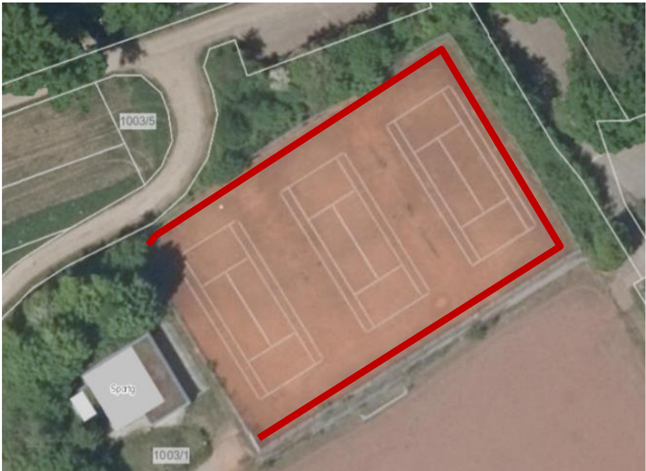
Abb.5: Lage des notwendigen Reptilienschutzzaunes bei Erhalt des bestehenden Zaunes (Alternative 1)
