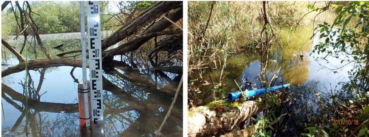
Abbildung 14: Messung des Wasserspiegels im Riedsee mit Pegellatte (links) und Datenlogger (rechts, in blauem Schutzrohr)
