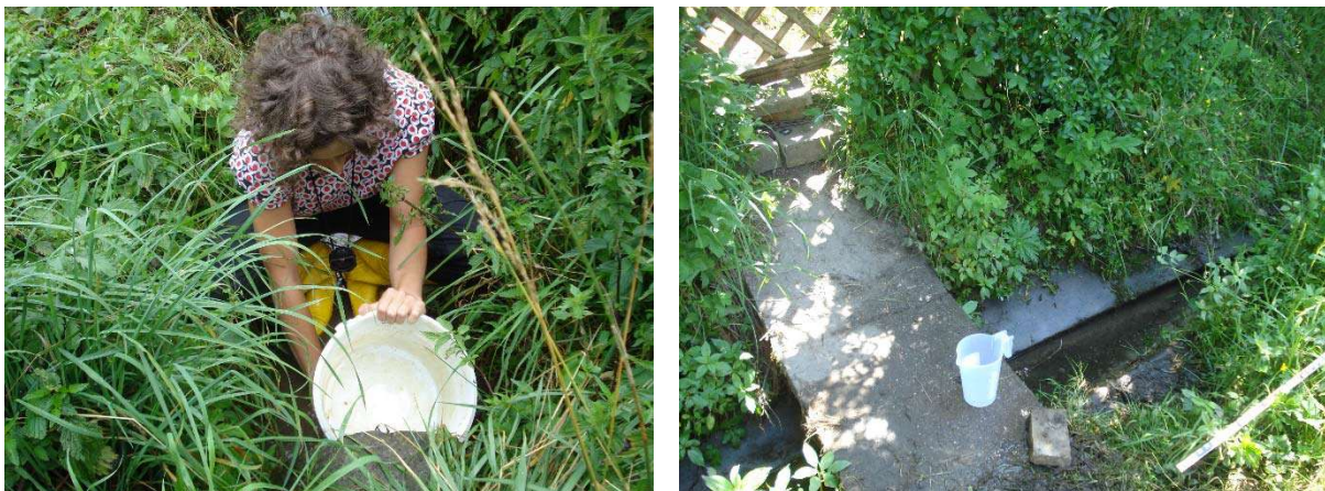
Abbildung 12: Messung der Abflussmenge mittels Eimer (links) und mittels Salzverdünnungsverfahren (rechts)
