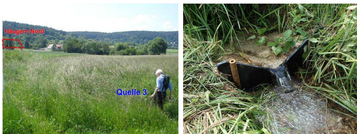
Abbildung 3: Umgebung von Quelle 3 und Messwehr am Quellaustritt (Austrittshöhe +388,8 m ü. NN [1])
